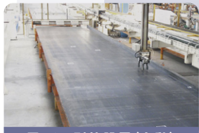
墨だし・型枠設置(自動)
