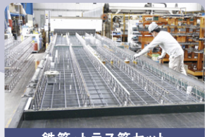
鉄筋・トラス筋セット
