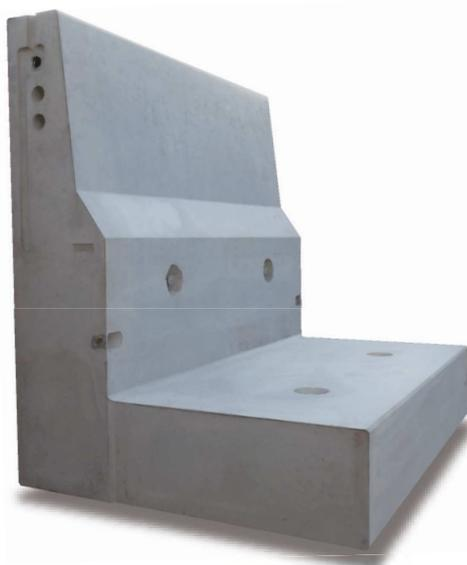
プレキャスト剛性防護柵として、現在実車実験により性能を確認されているのは、PC鋼材の緊張による一体化を図った仕様だけです。また、天端をプレストレスト構造にすることにより、衝突時の残留変位や天端局部破壊を抑制します。
