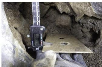
**摩擦** 引抜き試験により摩擦係数を確認できる
